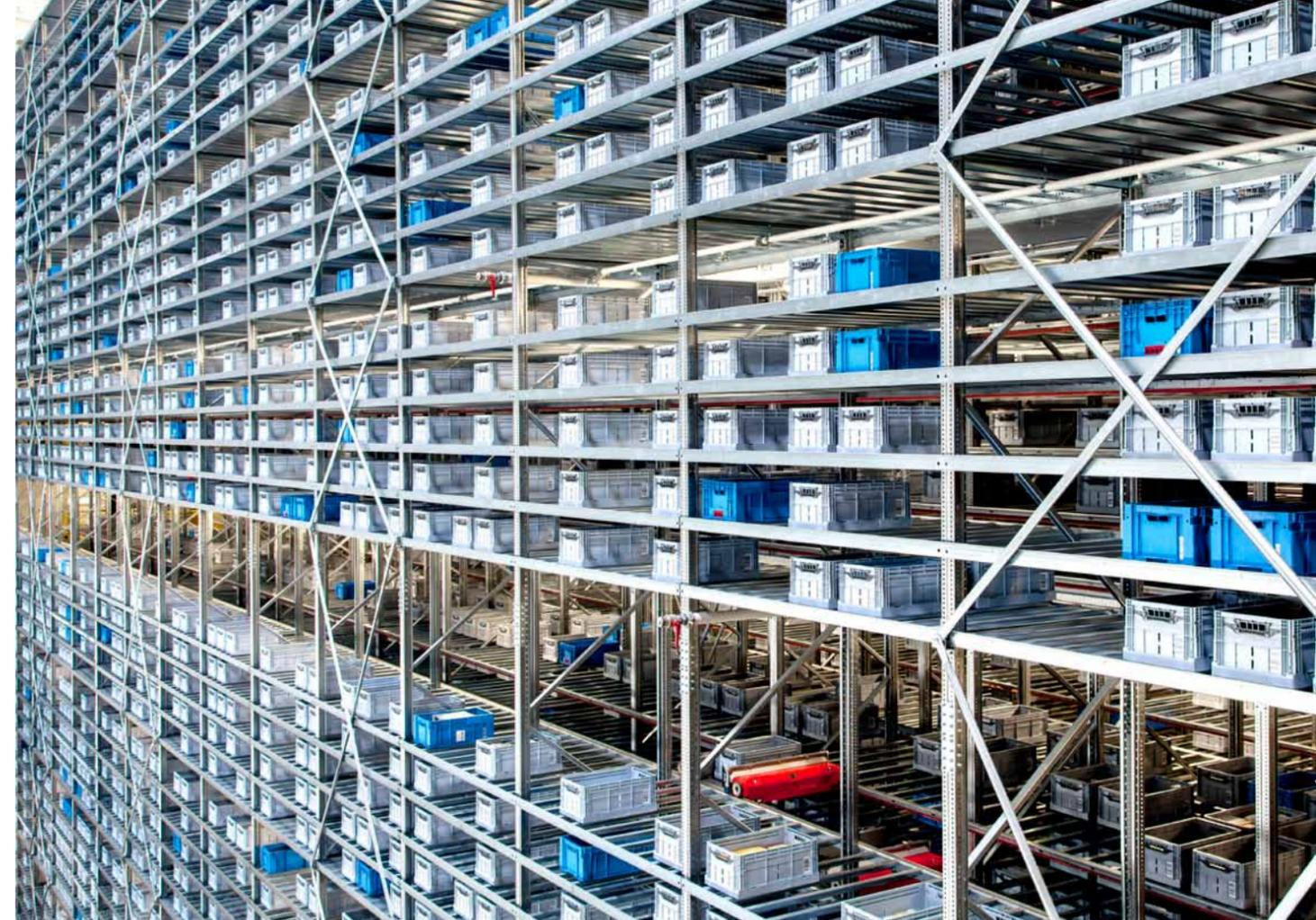
120 STINGRAY Shuttles versorgen bei Weltbild in Augsburg die Kommissionierung mit 5.500 Behältern pro Stunde
